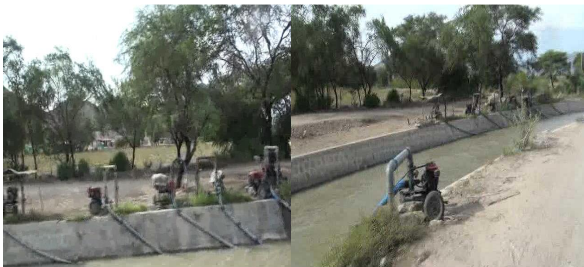
Usuarios informales de agua de riego, extrayendo agua del canal Taymi con motobombas situadas en los centros poblados de Keiko Sofía y Luya, distrito de Tumán.
